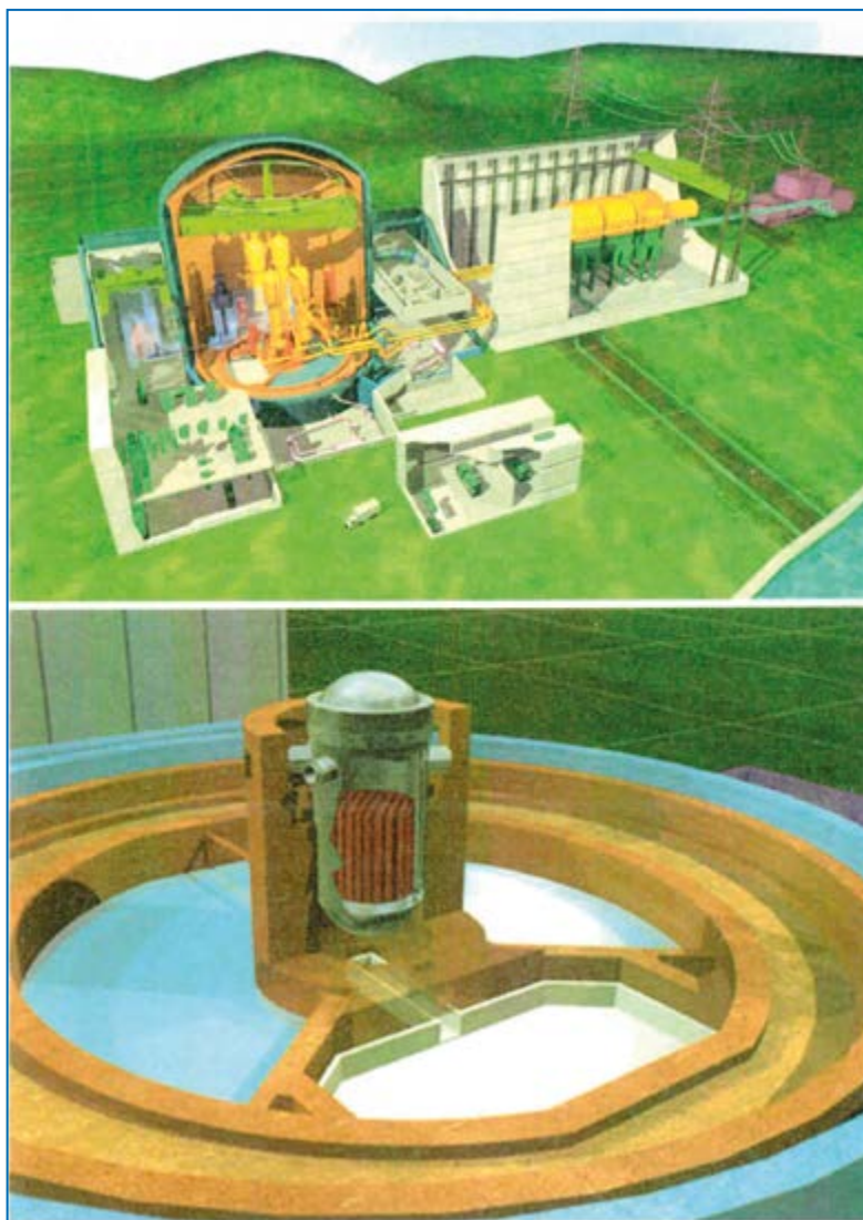
Figura 6 Il reattore EPR ed il dispositivo di raccolta del nocciolo fuso
